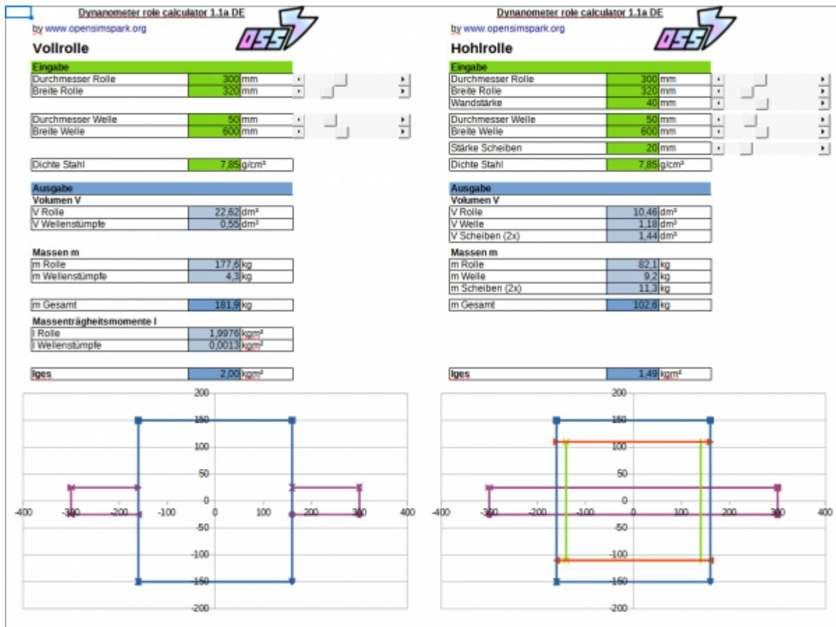
Wird der Außendurchmesser der Hohlrolle mit 400 mm statt 300 mm angenommen und die Wandstärke auf 24 mm reduziert:
